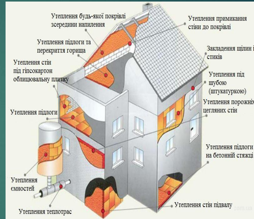
Рис. 1. Схема утеплення будівлі із зазначенням основних зон застосування теплоізоляційних матеріалів
