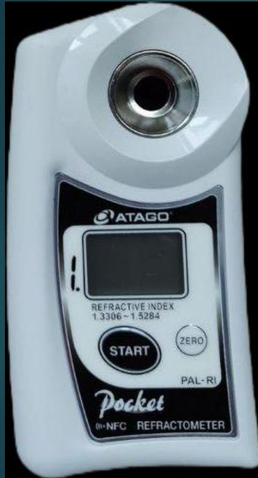
Рис. 14. Рефрактометр PAL-RI для визначення показника заломлення карбамідо-формальдегідної смоли
