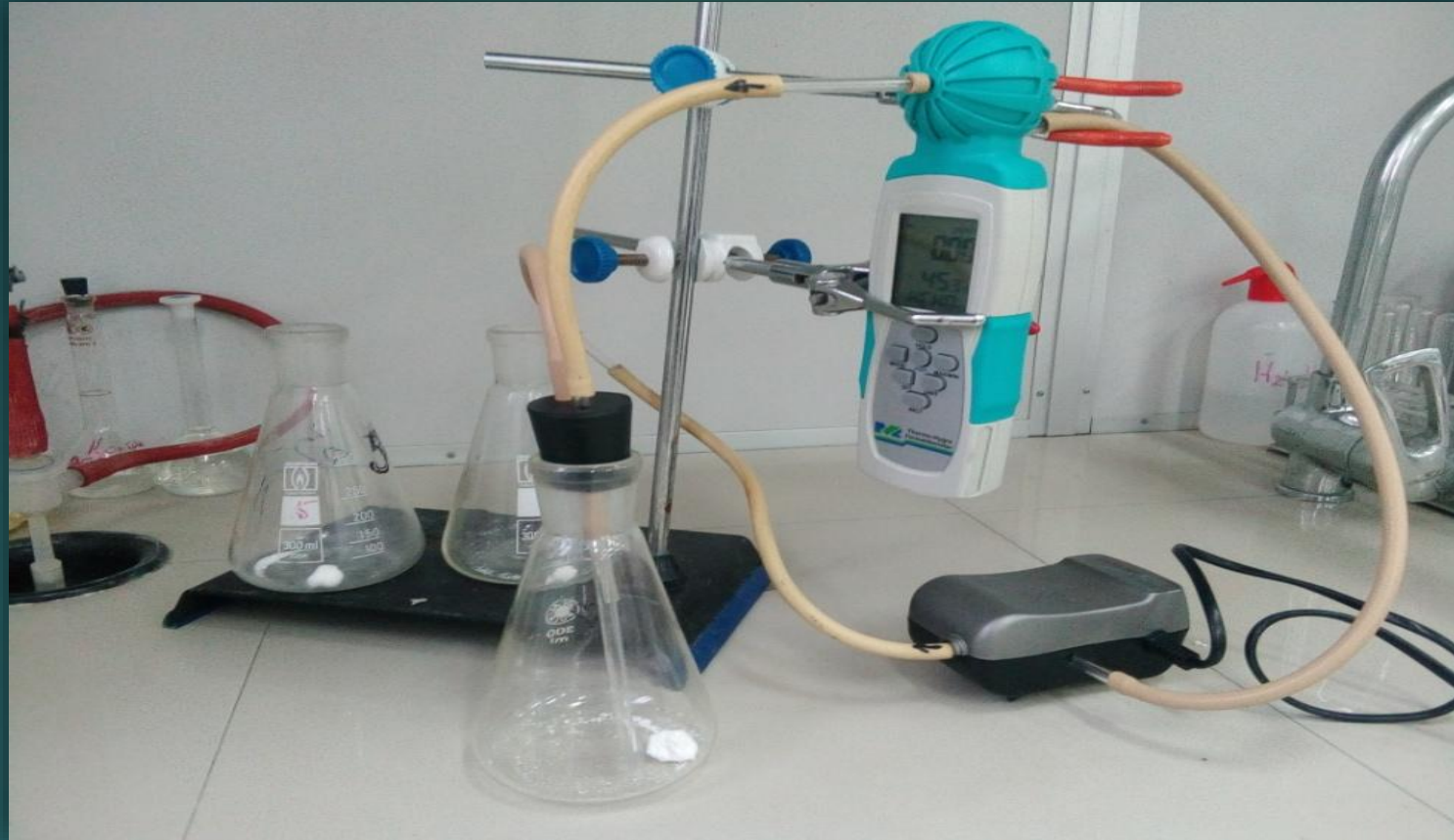
Рис. 10. Установка для вимірювання вмісту вільного формальдегіду: 1-Штатив; 2-Склянка Дрекслея. 3-Газоаналізатор на формальдегід МІС-98170, 4-Повітрорудка акваріумна для подачі повітря із двома трубками; 5-Зразок КФС або пінопласту в склянці Дрекслея
