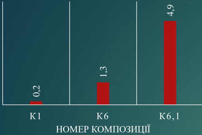
Рис. 17. Залежність проникності голки від складу композиції карбамідо-формальдегідного пінопласту
